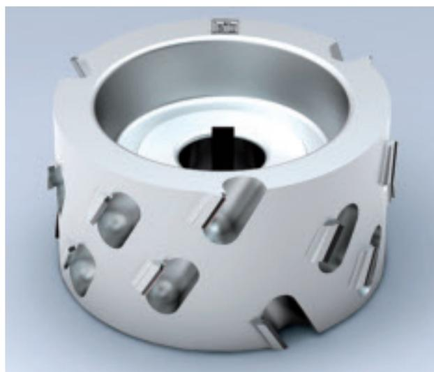
Fresadora para juntas Diamaster, tipo DP, de Leitz
