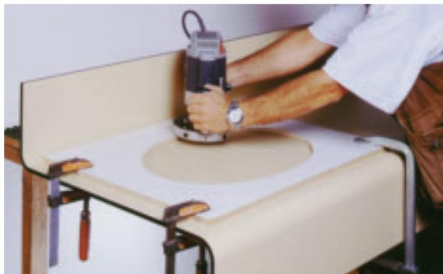
1. Dibuje la sección que debe recortarse y Hágalo con una fresadora.
