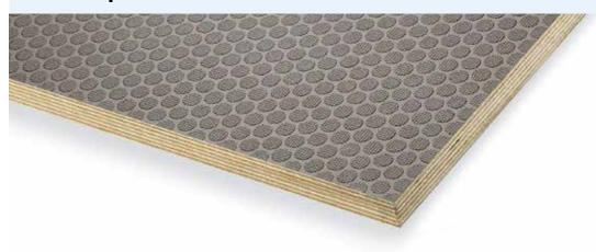
KoskiCrown consiste en un material duradero para suelos que va cubierto con un film fenólico. Durante el proceso de revestimiento, una figura con forma circular se imprime sobre la superficie del film mediante un pensado con calor. La figura se repite en un ángulo de 60 °. Su fondo está formado por un círculo con un diámetro de Ø10 mm.
