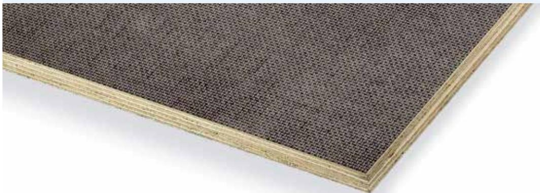
Es un contrachapado de abedul finlandés ó combi revestido por ambas caras con un film fenólico marrón altamente resistente al desgaste. En una o en ambas superficies se ha prensado mediante calor una figura en relieve en forma de rejilla de alambre antideslizante.
